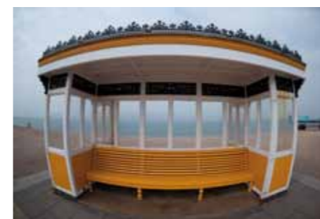
Tonnenförmige Verzeichnung und Randabschattung – charakteristische Abbildungsfehler des hier verwendeten Fisheye.
