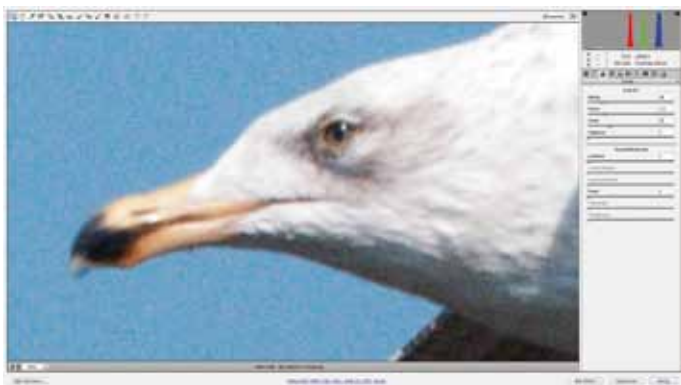
Digitales Rauschen tritt als Luminanz- oder Farbrauschen auf. Deutlich störend ist vor allem das Farbrauschen: Bunte Farbpixel sind dann in eigentlich homogenen Farbflächen vorhanden.
